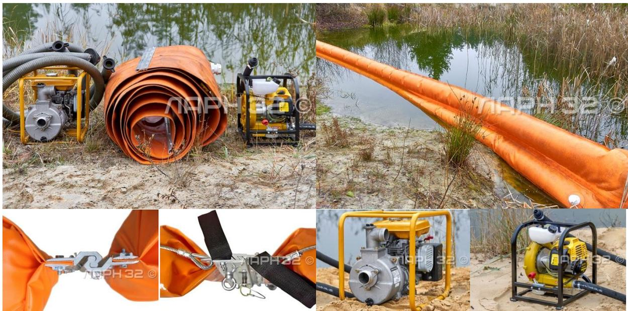
Универсальность конструкции **бона берегозащитного** позволяет гибко устанавливать его в различных условиях, как в прибрежной полосе и на берегу, так и на мелководье и болотистой местности. Боны БНбз можно так же использовать как водоналивные дамбы.
