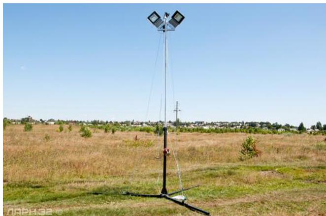
Направление освещения можно изменять не разбирая установку, достаточно опустить прожектора, отрегулировать направление и поднять прожектора. Подъем и опускание прожекторов осуществляются с помощью лебедки. Установка может подключаться к сети бытового напряжения 220В или оснащаться бензо- или дизель-генератором для автономной работы.
