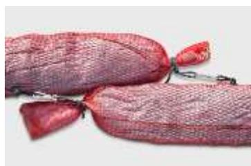
**Боны сорбирующие усиленные** с наполнителем «КоркСорб®» – отличаются от сорбирующих бонов внешней оболочкой из прочной полимерной сетки, наличием силового элемента – каната, проходящего вдоль бона и карабинами для быстрого и надежного соединения бонов в цепь. Специальная конструкция позволяет соединять боны с перекрытием, что полностью предотвращает протекание нефтепродукта в местах соединений сорбирующих бонов.
