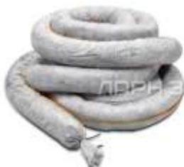
**Минибоны сорбирующие** – с наполнителем «КоркСорб®», отличаются небольшим диаметром и простотой конструкции. Минибон представляет собой рукав из спанбонда, наполненный гидрофобным сорбентом «КоркСорб». На краях минибона есть завязки для соединения бонов друг с другом.
