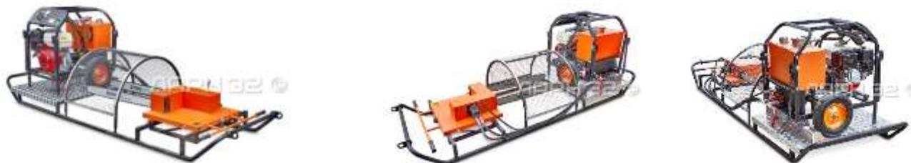
В отличие от ледорезных установок «ЛУ» с бензопилами, цепные гидроприводные установки **оснащаются гидроприводом пильного блока**, который даёт ряд преимуществ: увеличивает мощность пильного блока в работе, повышает надёжность при длительной эксплуатации, а также даёт возможность использовать экономичный и более безопасный дизельный двигатель гидростанции.
