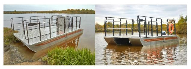
Габариты и обводы **катамарана КБ-1** обеспечивают судну хорошую продольную и поперечную остойчивость, минимальные крены и высокую сопротивляемость к переворачиванию, а так же устойчивость на ходу и надежную управляемость. Небольшая осадка катамарана позволяет работать на мелководье и прибрежной полосе.
