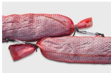
**Боны сорбирующие усиленные** – отличаются от сорбирующих бонов внешней оболочкой из прочной полимерной сетки, наличием силового элемента – каната, проходящего вдоль бона и карабинами для быстрого и надежного соединения бонов в цепь. Специальная конструкция позволяет соединять боны с перекрытием, что полностью предотвращает протекание нефтепродукта в местах соединений сорбирующих бонов.
