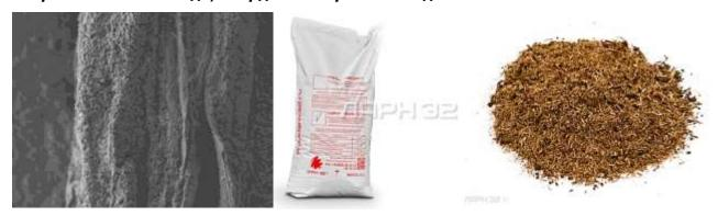
**Сорбент "БиоНьюсорб"** применяется для ликвидации разливов сырой нефти и нефтепродуктов с последующим их биоразложением на водной и твердой поверхности. Легко наносится шанцевым инструментом или распылителем сорбента APC.
