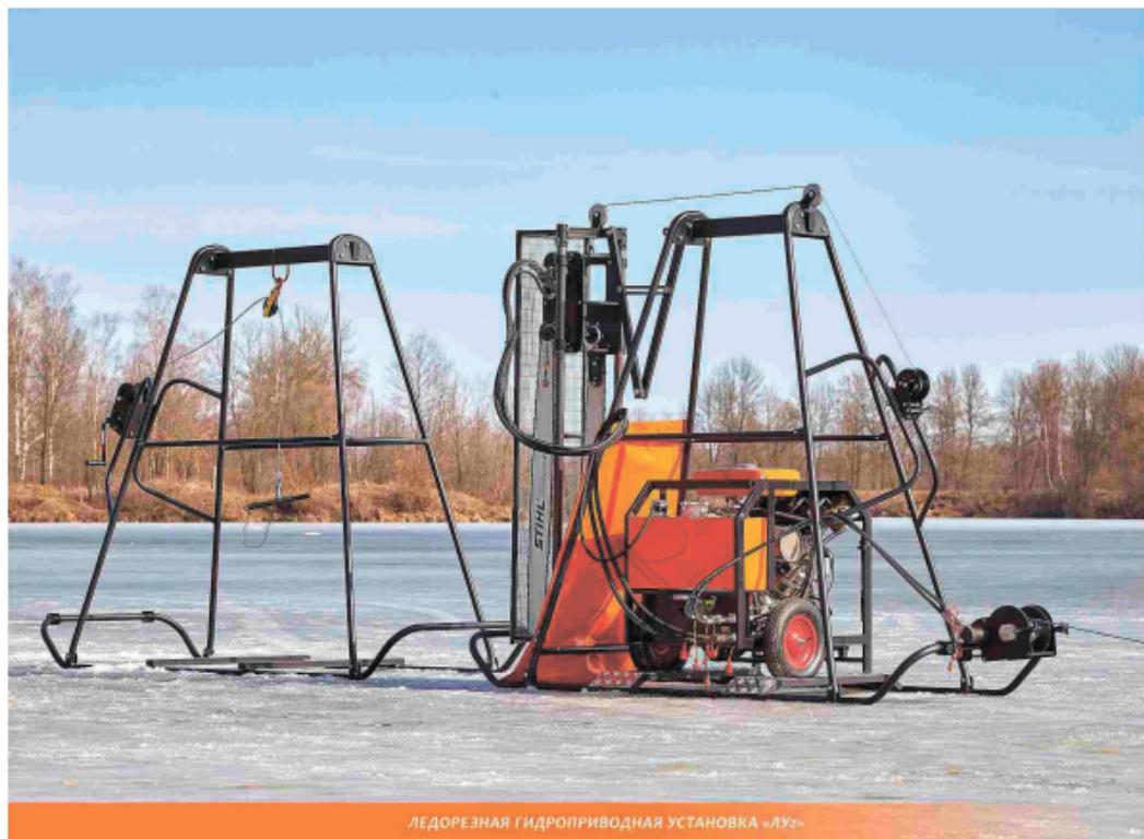
ЛЕДОРЕЗНАЯ ГИДРОПРИВОДНАЯ УСТАНОВКА «ЛУГ»
