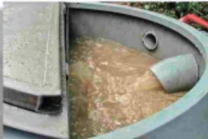
Сепаратор «СНВ» был специальным спроектирован для работы в цепочке оборудования для сбора аварийных разливов нефти. Сепаратор подключается к нефтесборному оборудованию и непрерывно разделяет поступающую смесь на воду и нефтепродукт. Очищенная от нефтепродукта вода сливаются в водоем, а отделенный нефтепродукт собирается в резервир временного хранения.
