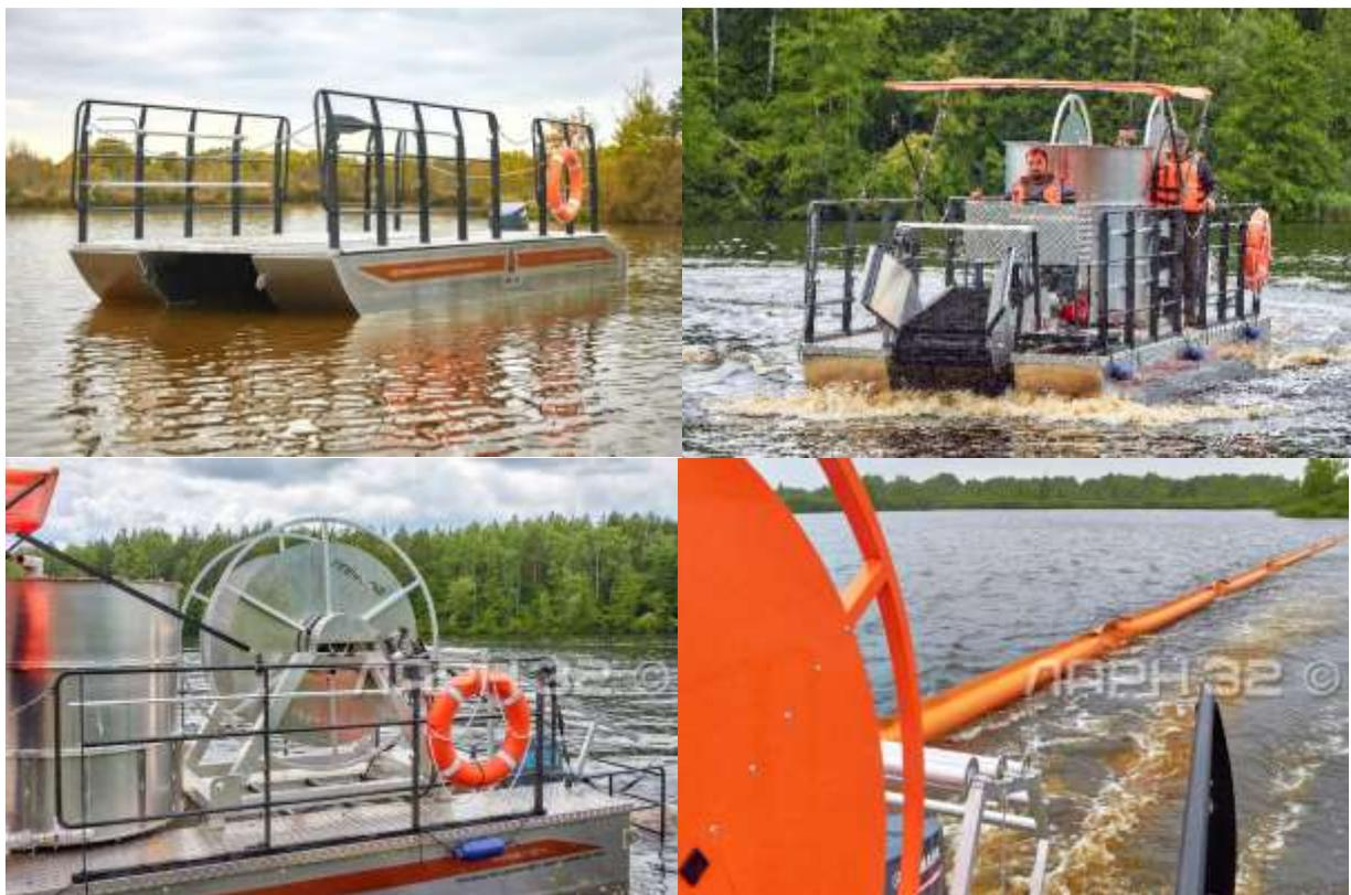
Габариты и обводы **катамарана КБ-1** обеспечивают судну хорошую продольную и поперечную остойчивость, минимальные крены и высокую сопротивляемость к переворачиванию, а также устойчивость на ходу и надежную управляемость. Небольшая осадка катамарана позволяет работать на мелководье и прибрежной полосе.
